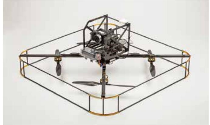
ジンバル、点検撮影用カメラ、映像伝送装置のほか、橋梁下での運用を想定したジンバルガードを装着。さらにオプションの有線給電ケーブルを用いることで長時間の点検業務にも活用できます。
