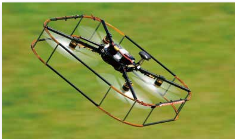
高性能バッテリー、Li-Po 3セル38Whによるパワフルなフライト。ペイロードなしで約10分のフライトが可能となっています。
