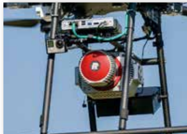
リーグル社のハイエンドレーザースキャナ「VUX-1UAV」を搭載しています。
