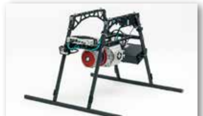
脚部分の取り外しが可能。機械類の交換が容易にできます。
