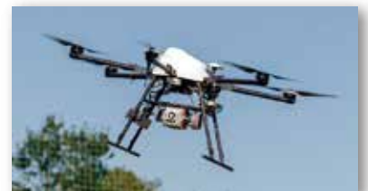
バッテリー電圧低下時における自動帰還システムを搭載。安全な運用をお約束します。
