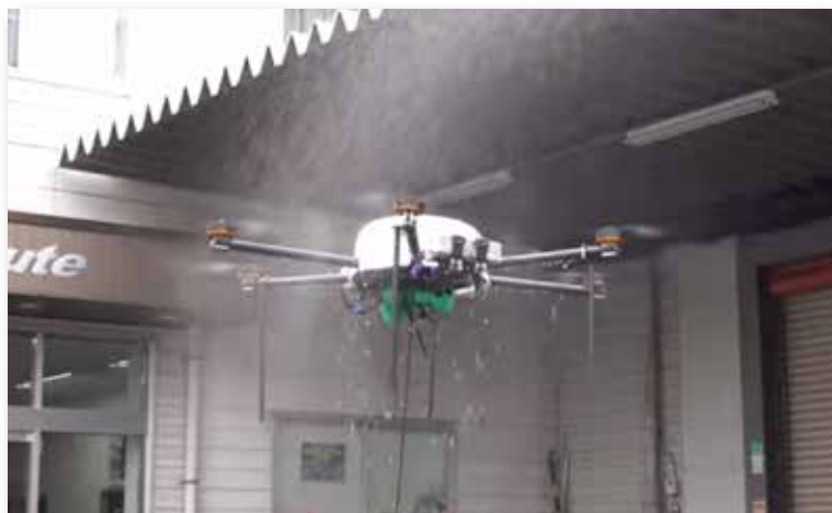
独自開発した防滴システムにより雨の中での作業にも対応。 ※防滴仕様はオプションです また、カメラ等の搭載物は除きます
